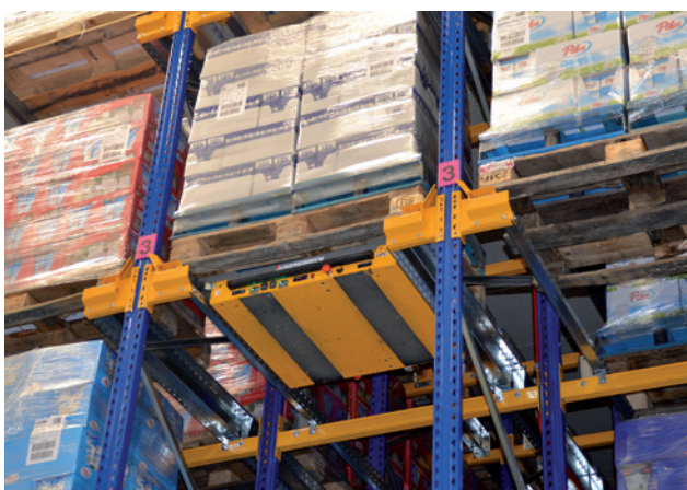
UPC modul automaticky zaskladňuje a vyskladňuje palety v kanálu, do kterého je umístěn.
