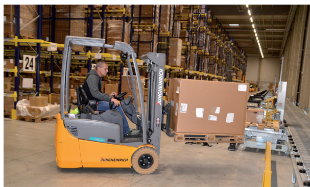
Čelní vysokozdvíhací vozíky přepravují palety z válečkové dráhy na místo určené pro odebrání systémovým vozíkem.
