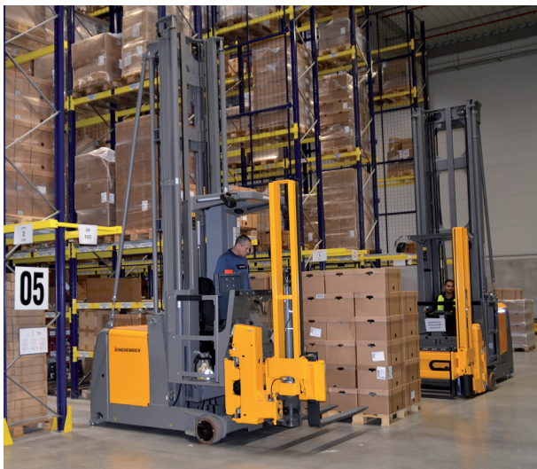
Systémové vozíky slouží ve skladu společnosti Tchibo Praha k zakládání celých palet.
