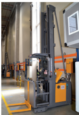
Proces nabíjení je nejen rychlý, ale hlavně bezpečný, baterie zůstává uvnitř vozíku.
