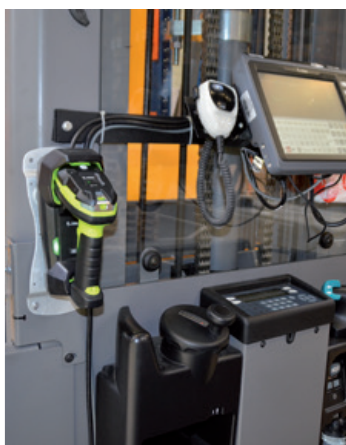
Vozíky jsou vybaveny skenery s napojením na WMS.
